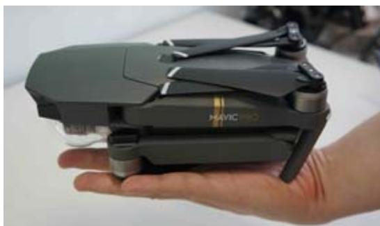
Рис. 1. Малые габариты квадрокоптера в сложенном состоянии.
